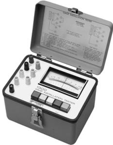
Messung des Isolationswiderstands DMS/Messobjekt mit 15VDC, Messbereich 0 bis 20GΩ.
