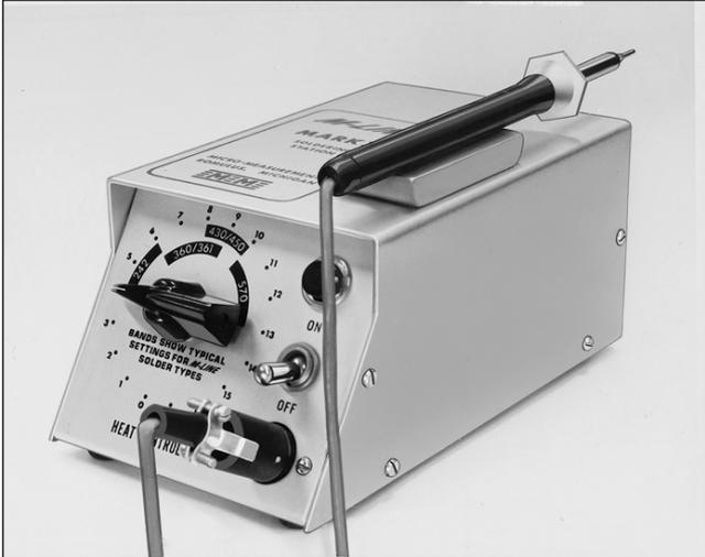
Lang erprobte Präzisions-Lötstation, besonders geeignet für kleinste Lötstellen und sonstige delikate Lötarbeiten. 25W Leistung in 17 einstellbaren Temperaturstufen für alle M-Line Lötzinne. Magnet-LötKolbenhalter und flexibles, feuerfestes Kabel. Leichter LötKolben (31g). Für Anschlusswerte 115VAC oder 220VAC, 60 oder 50Hz.
