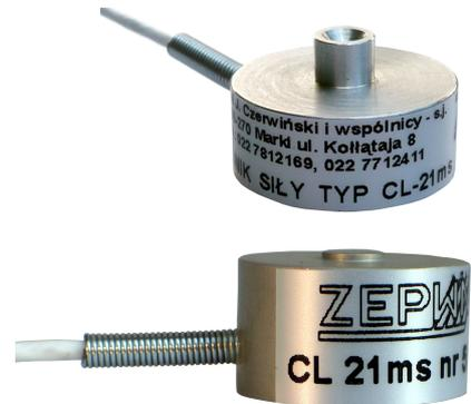
Der Federkörper des Aufnehmers wird aus Stahl oder Aluminium gefertigt und ist mit einer Präzisions-DMS-Vollbrücke bestückt. Die Brückenschaltung ist abgeglichen und temperaturkompensiert.
