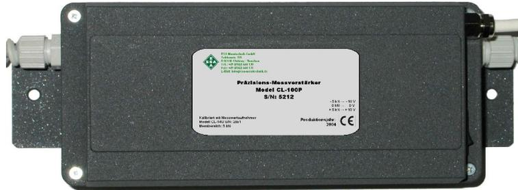
Der Hochpräzisions-Gleichspannungsverstärker CL 100P ist für den Messeinsatz mit 120 Ω bis 1200 Ω DMS-Vollbrückenschaltungen gedacht. Seine robuste Konstruktion macht ihn besonders geeignet für Einsätze in schwierigen industriellen Umgebungsbedingungen, wenn ein hoher Grad an Schutz gegen Staub, Feuchtigkeit und mechanische Schwingungen erforderlich ist.
